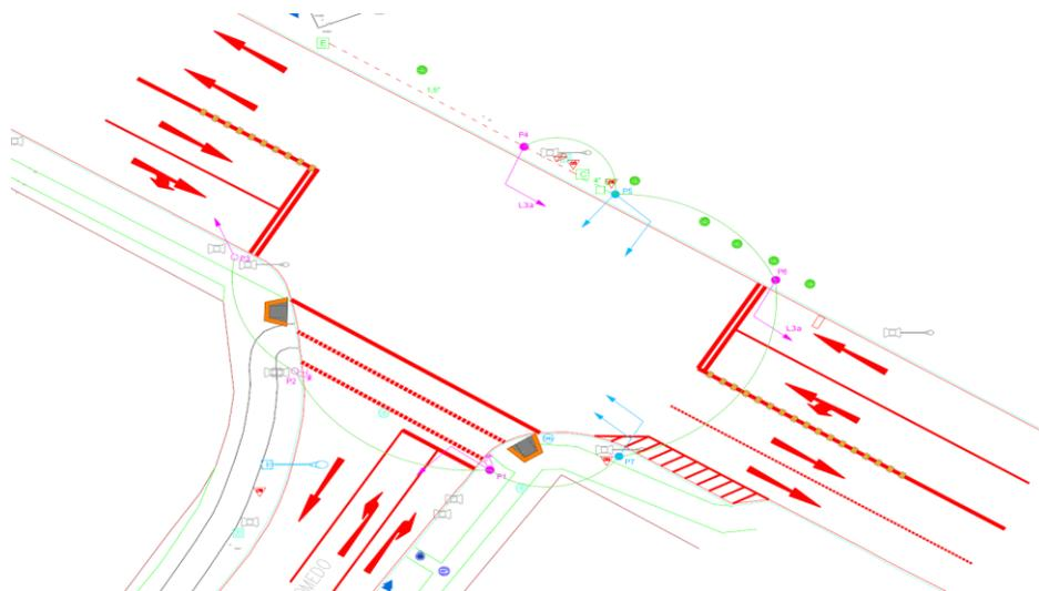
**Mitigación Paliativa:** Provisión e instalación de dispositivos semaforizados, señalización, sustitución del controlador subnorma y reprogramación.
