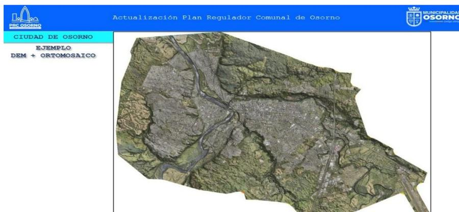
Aquí podemos ver el orto-mosaico montado sobre el modelo digital de elevación, y ustedes ven que sobre las fotos empiezan a aparecer como en 3D las cosas y uno ve las laderas o como se están conformando los cerros, las partes más llanas y las más altas, para eso sirven estos elementos básicos.
