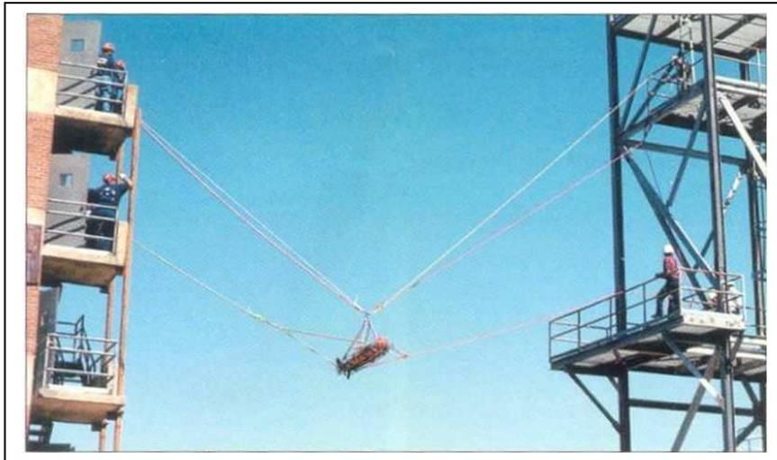
Este es el simulador de rescate en altura, actualmente existe en Talagante, estos son simuladores que se utilizan especialmente en Europa. El cuerpo de bomberos de Osorno lo que tiene en diseño es una torre de este tipo, con la posibilidad de tener dos torres para trabajar en altura, y hacer este rescate de edificio a edificio a través de cuerdas.
