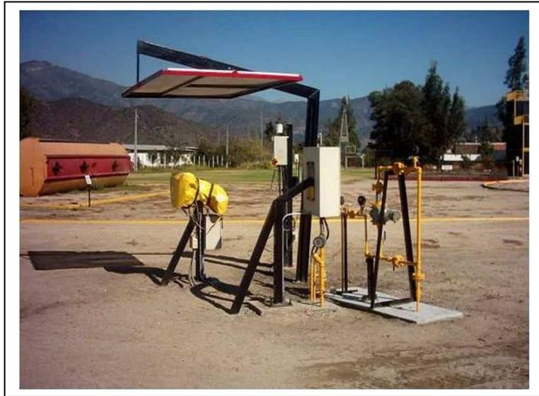
Este simulador asemeja una estructura tridimensional industrial, donde pueden generarse fallas, filtraciones, lo cual conlleva a un gran desprendimiento de temperatura y fugas de combustible, en lo cual hay que aprender a controlar estas temperaturas y que nos permita llegar a las llaves para cerrar estos flujos y así controlar la emergencia.
